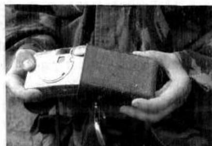
камера в твердом водонепроницаемом чехле
